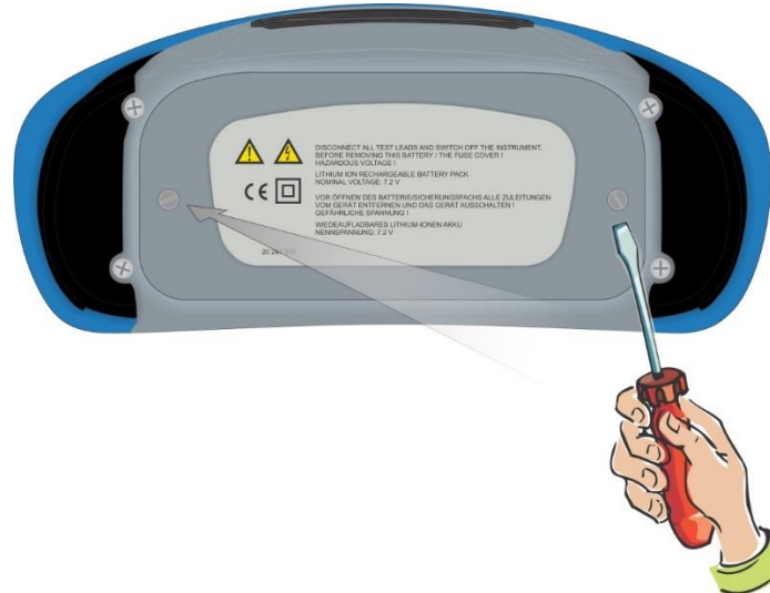
Abbildung 14.1: Position der Schrauben zum Öffnen des Batterie-/Sicherungsfachs
