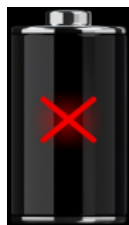
Abbildung 2.5: Akku-Fehleranzeige (Ladevorgang unterbrochen, Timer-Fehler, Akku nicht vorhanden)
